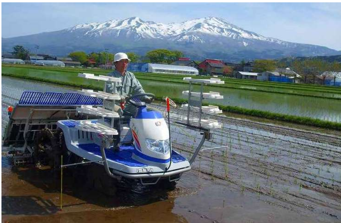
鳥海山をバックに「さなえ PZ70」での疎植田植えでは予備苗を載せなくとも大丈夫です。
